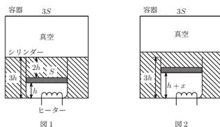
次に、ヒーターを用いて気体を加熱すると、ピストンはゆっくりと上昇した。図2のように、ピストンの底面からの高さが  $h + x$  ( $> h$ ) となったときについて考える。
